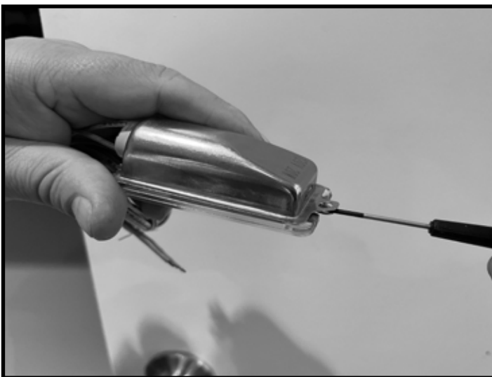
Figure 2: Insérer un petit tournevis à tête plate
